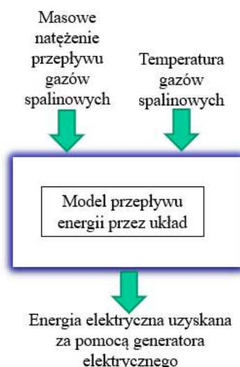
Rys. 2. Model uwzględniający dane wejściowe i wyjściowe układu ORC. Źródło: opracowanie własne.
